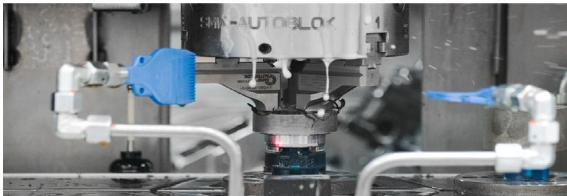
Puisqu'elles sont isotropes, les pièces imprimées avec la technologie SLA, comme ce gabarit de chez Pankl Racing Systems, peuvent résister aux différentes forces directionnelles subies lors des opérations de fabrication aux contraintes importantes.
