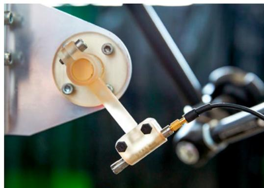
Les ingénieurs de l'AMRC utilisent un parc de 12 imprimantes 3D SLA et de nombreux matériaux techniques afin d'imprimer des pièces sur mesure pour divers projets de recherche, comme des attaches pour un robot de transfert (gauche) et des supports pour capteurs dans un environnement avec une température élevée (droite).
