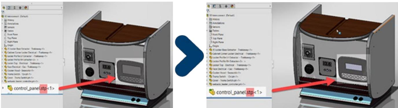
**Une autre fonction qui permet de travailler avec la géométrie importée est le complément FeatureWorks.** Ce complément permet de reconnaître des géométries et de les transformer en fonctions **SOLIDWORKS**. De plus, il n'est pas nécessaire de reconnaître la géométrie complète de la pièce. On veut changer la dimension d'un congé ou le diamètre d'un trou? Il suffit de reconnaître seulement cette géométrie et le tour est joué.
